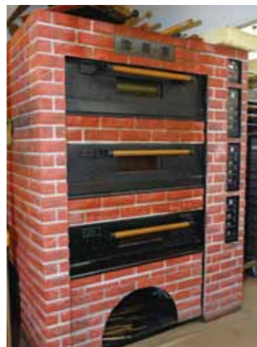
溶岩から切り出したプレートを窯内内部に使用している溶岩窯。熱の通りが早いため乾燥しづらく、しっとりとした食感の焼き上がりになるのだとか
