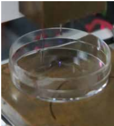
補助金で購入した画像処理装置(上)。細い電極からシャーレ中央にプラズマを照射した瞬間。紫色の閃光が見える(下)
