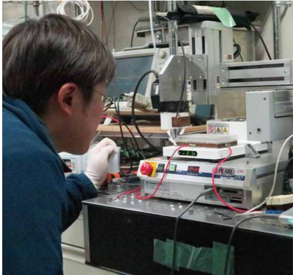
卓上の機器が遺伝子導入装置。パソコンでパラメータを制御しながら、標的となる細胞にプラズマを照射する。今回の補助事業では、本装置と組み合わせて使用する画像処理装置を導入した
